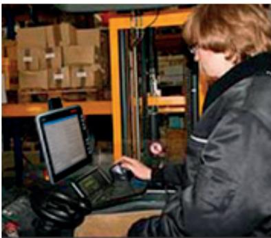
Die IPC basieren auf einer energiesparenden Intel® Dual Core-, Intel® Quad Core-, Intel® Core i3- oder Intel® Core i5-Architektur in einem extrem schlanken und leichten Gehäuse.
