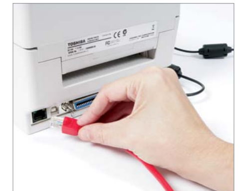
Eingebaute Netzwerkkarte mit 10/100Mbps LAN Interface
