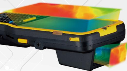
➤ Mit Hilfe eines Temperatursensors und einer Software zur Kontrolle können Nutzer die Heizvorrichtung je nach Umgebung so einstellen, dass sie sich automatisch ein- bzw. ausschalten kann. Stellen Sie z. B. ein, dass sich die Heizvorrichtung bei unter -10 °C einschaltet und bei über 20 °C ausschaltet.
